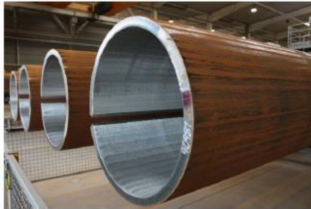
Figura 7- Placas curvadas, a parte interior é de clad e a exterior feita de aço
